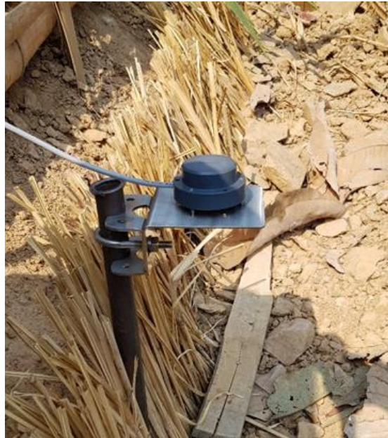
รูปที่ 7.8 อุปกรณ์ Tiltmeter สำหรับวัดการเคลื่อนตัวที่ผิวดิน
