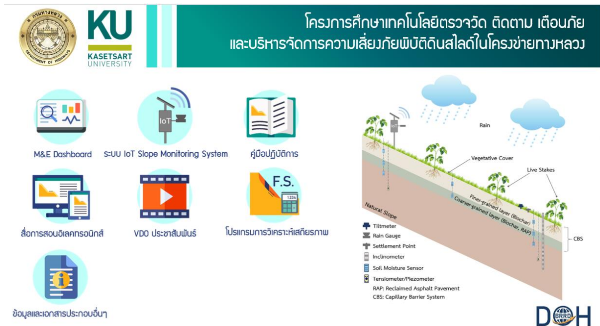
รูปที่ 7.19 ตัวอย่างหน้าจอควบคุม (Dashboard) ของระบบ RRD Slope Monitoring Online Interactive Platform หน้าแรก
