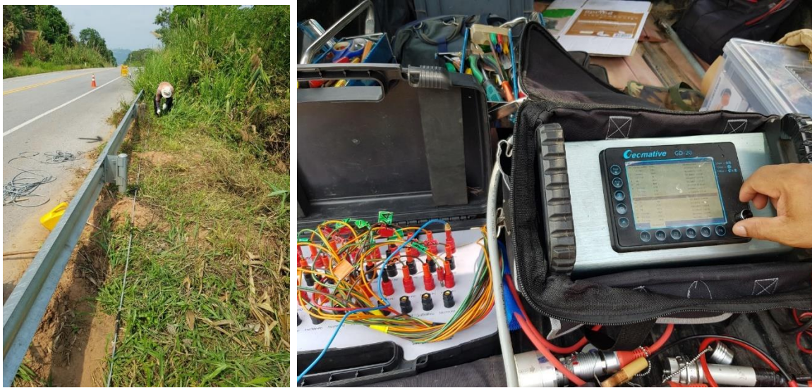
รูปที่ 2.16 การติดตั้งและดำเนินการทดสอบค่าความต้านทานไฟฟ้าในสนาม
