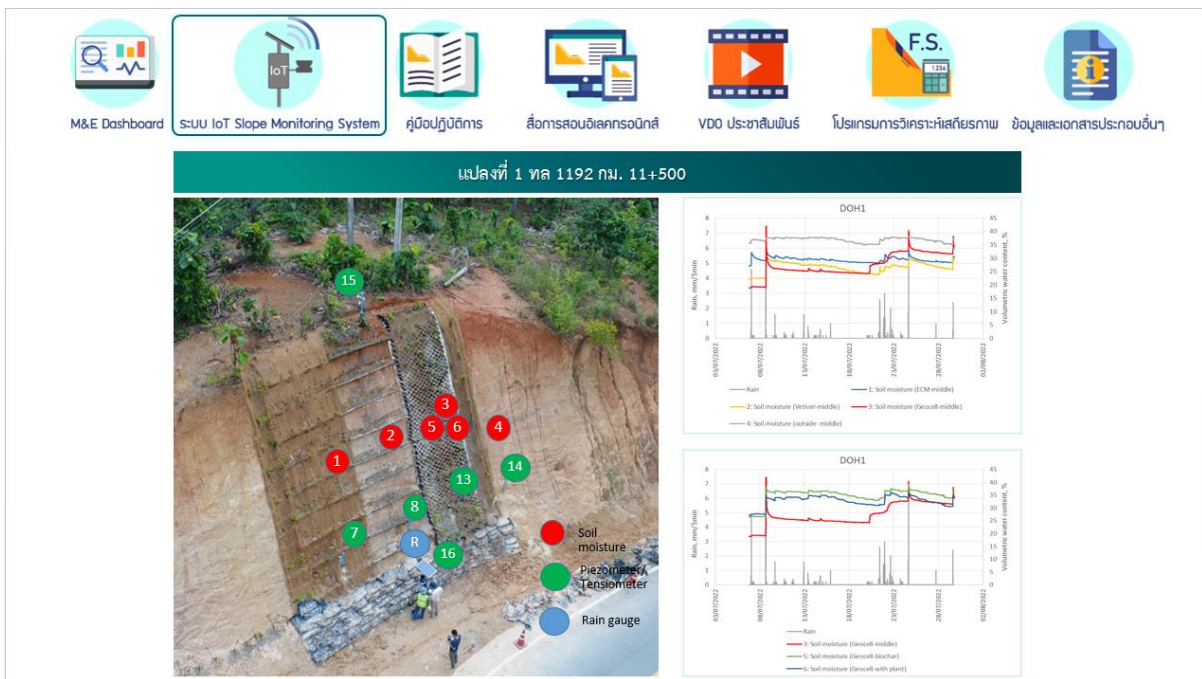
รูปที่ 7.23 ตัวอย่างหน้าจอควบคุม (Dashboard) ของระบบ RRD Slope Monitoring Online Interactive Platform โมดูล 2) IoT Slope Monitoring System
