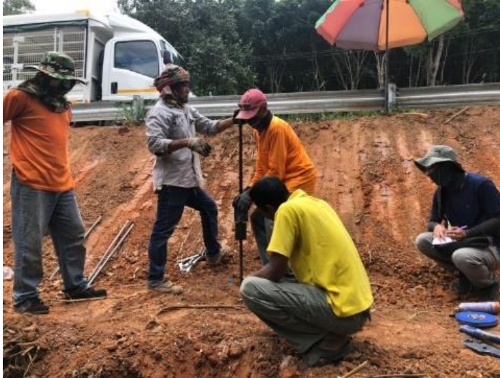
รูปที่ 2.21 อุปกรณ์ Kunzelstab และการทดสอบ
