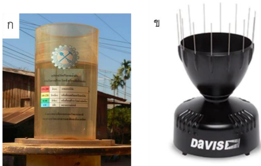
รูปที่ 7.2 อุปกรณ์วัดน้ำฝน 1) กระบอกวัดน้ำฝน 2) เกจวัดน้ำฝนแบบคานกระดก (Tipping Bucket Rain Gauge)
