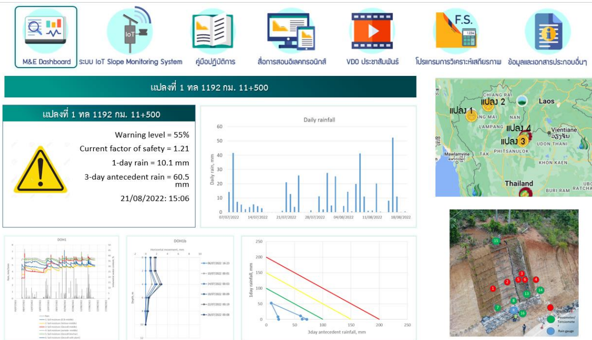
รูปที่ 7.21 ตัวอย่างหน้าจอควบคุม (Dashboard) ของระบบ RRD Slope Monitoring Online Interactive Platform โมดูล 1) Monitoring and Evaluation (M&E)
